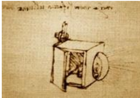
Ил. № 34. Осветительный прибор, или прожектор Леонардо да Винчи. Прожектор представлял собой обычный ящик, с одной стороны которого располагалась большая стеклянная линза. Источником света была свеча. Работая в Милане, Леонардо использовал свое изобретение в театральных постановках для проекции увеличенных теней на стене. Меняя размер предмета с помощью освещения, он создавал тени с чёткими или размытыми очертаниями.
